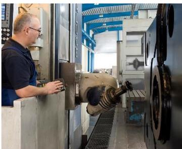
Die mechanische Bearbeitung von Bauteilen und Baugruppen bis zu einer Größe von 12.000 x 4.200 mm und einem Gewicht von 60 Tonnen führen wir an unserem Standort in Hessisch Lichtenau durch.
