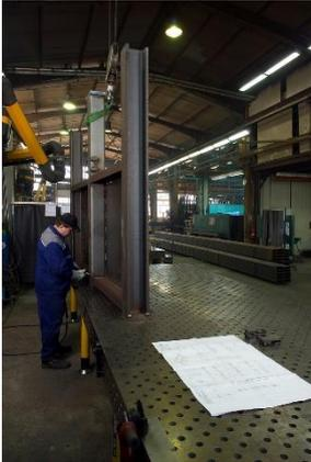
Mit modernen Schweißanlagen und gut ausgebildetem Schweißfachpersonal werden bei FST Schweißbaugruppen in Einzel- oder Serienfertigung hergestellt.
